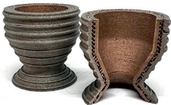
Рис. 3. Мультиматериальные модели с сетчатыми элементами и заданными свойствами
