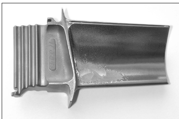
Рис. 5. Внешний вид лопатки РД-33 из сплава ЖС26НК с вакуумно-плазменным NiCrAlY-покрытием (СДП-2) после облучения СИЭП ( w = 40 \div 42 Дж/см 2 , \tau = 40 мкс)
