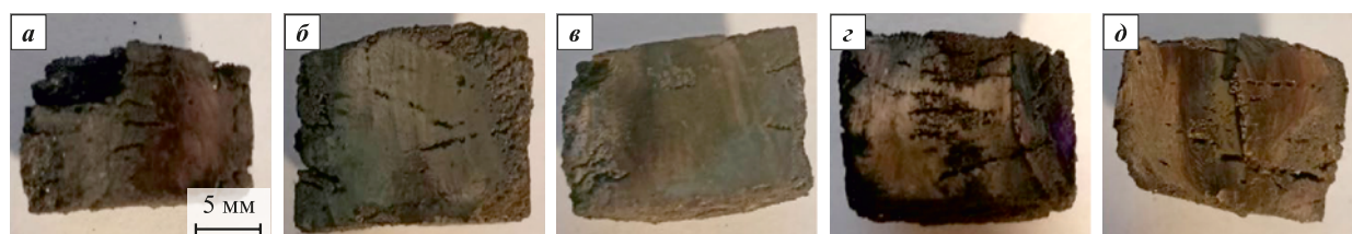
Рис. 4. Фотографии шлифов синтезированных образцов керметов TiC–Cu из СВС-шихты с 10 %-ной добавкой меди при различных давлениях ее прессования P , МПа: 22 (а), 34 (б), 45 (в), 56 (з), 69 (д)
