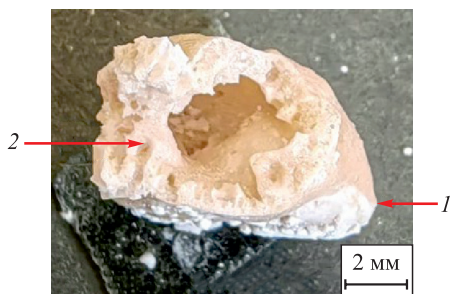
Рис. 2. Фотографическое изображение керамического продукта (Y_{0.2}Yb_{0.2}Lu_{0.2}Eu_{0.2}Er_{0.2})_3Al_5O_{12} каплеобразной формы (1) с поперечным сколом (2)
