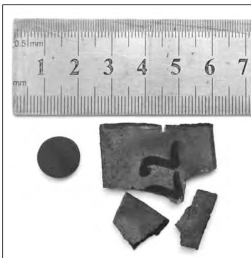
Рис. 4. Компактированное покрытие и изготовленный из него образец для определения теплофизических свойств
