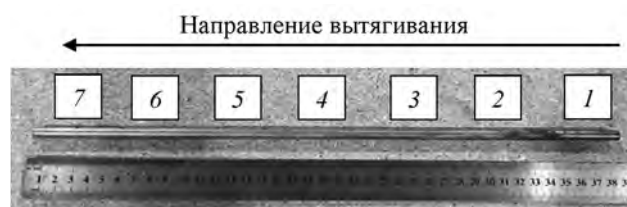
Рис. 2. Внешний вид образца Cu—Fe-сплава, полученного методом ВИП
