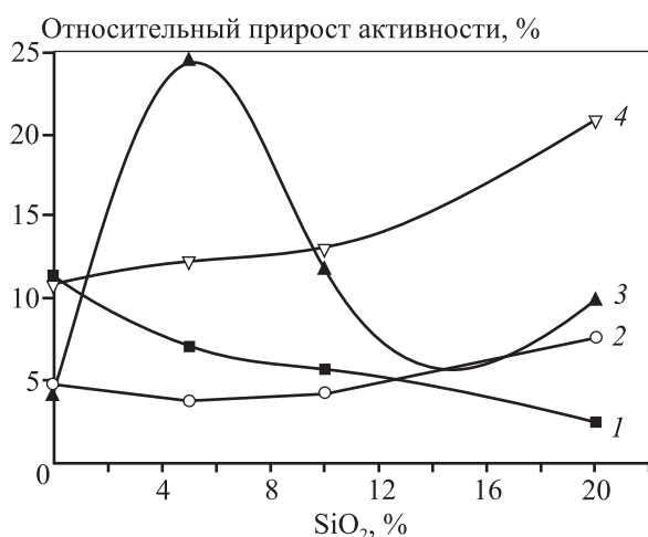
Рис. 6. Относительный показатель прироста активности алюминия в Al-композитах с различными модификаторами после МХО в зависимости от содержания SiO 2 1 – 5 % С, 2 – 20 % С, 3 – 3 % СК, 4 – 20 % ПВС
