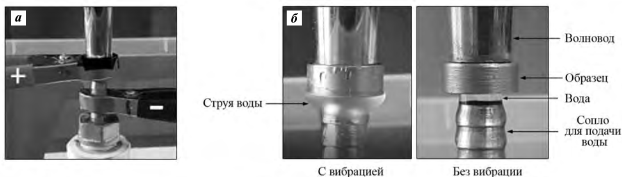
Рис. 3. Вид установки для кавитационных испытаний
