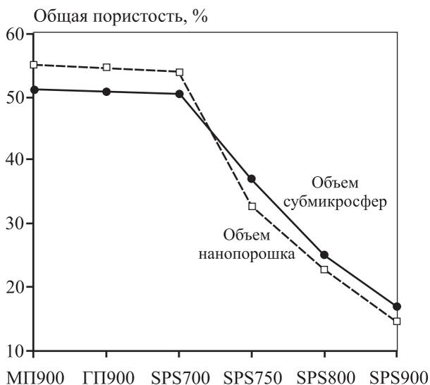
**Рис. 9.** Значения общей пористости для образцов МП900, ГП900 и SPS700–SPS900
