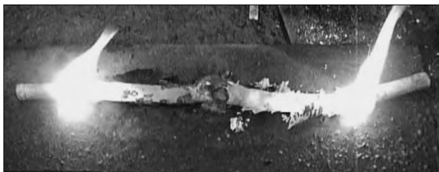
Рис. 1. Вид горения двух «сигарных» образцов СВС-шихты системы Ti—Cu—C
