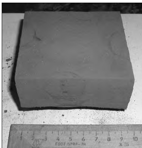
Рис. 6. Фотография полученного спека состава 3 массой 500 г
