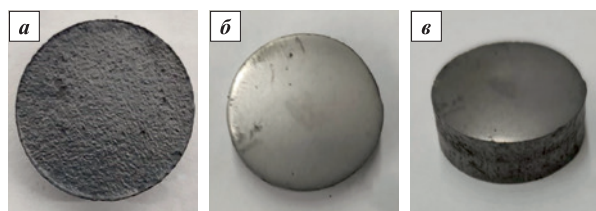
Рис. 3. Фотографии образцов (\text{TiZrHfTaNb})\text{C} диаметром 20 мм, спеченных при температуре 2000 °C
