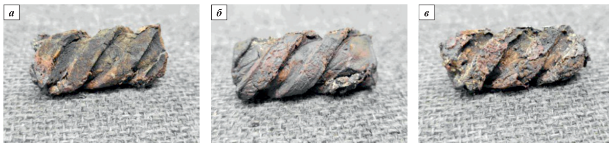
Рис. 8. Тестовые матричные образцы после спекания на воздухе при t = 900\text{ °C} (а), 1000\text{ °C} (б) и 1100\text{ °C} (в)
