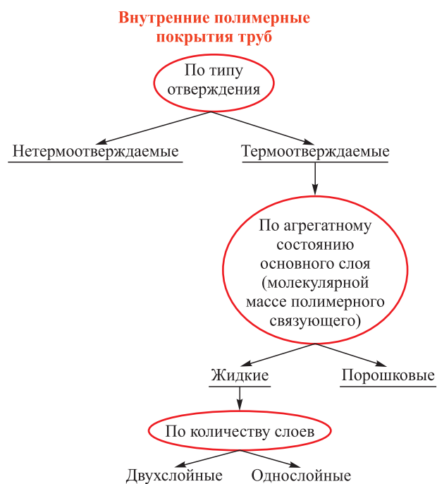
Рис. 4. Классификация полимерных покрытий, применяющихся для защиты внутренней поверхности НКТ
