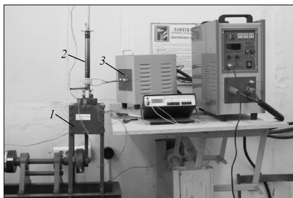
**Рис. 1.** Внешний вид установки для механического плакирования порошков
