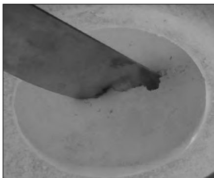
Рис. 4. Образец литого материала, нагретый до 1050 °С
