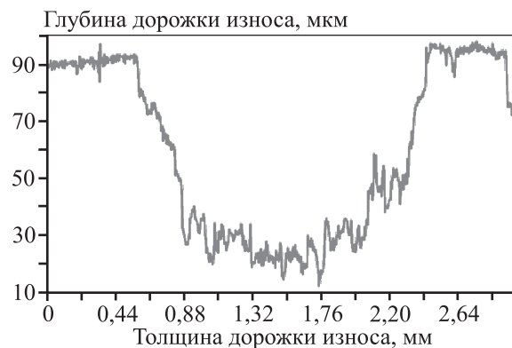
Рис. 11. Профилограмма дорожки износа образца газопламенного покрытия \text{Al}_2\text{O}_3\text{--TiO}_2 серии I
