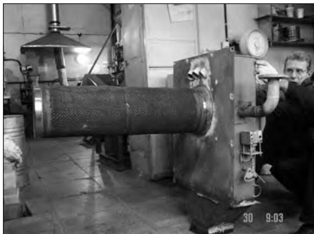
**Рис. 3.** Фильтрационный элемент + горелка ГГ-2
