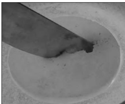
Рис. 4. Образец литого материала, нагретый до 1050 °С
