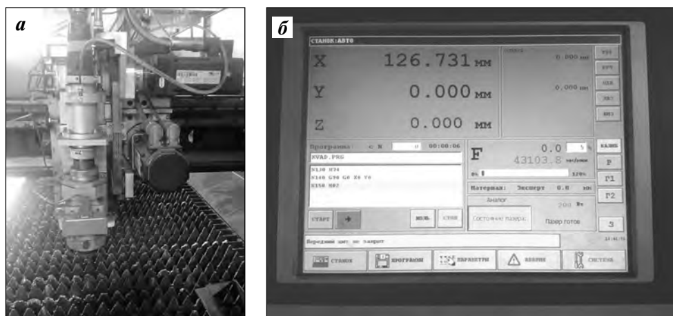
Рис. 1. Внешний вид (а) и дисплей управления (б) иттербиевого волоконного лазера ЛК 3015лс07
