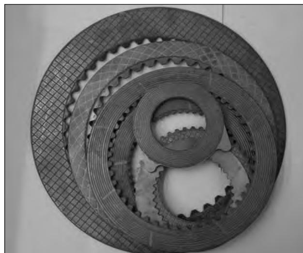
**Рис. 3.** Фрикционные диски, применяемые в тормозных узлах тракторов «Беларус»
