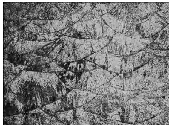
Рис. 3. Оптическое изображение микроструктуры образца 12X18H10T, полученного СЛС ( $\times 200$ )
