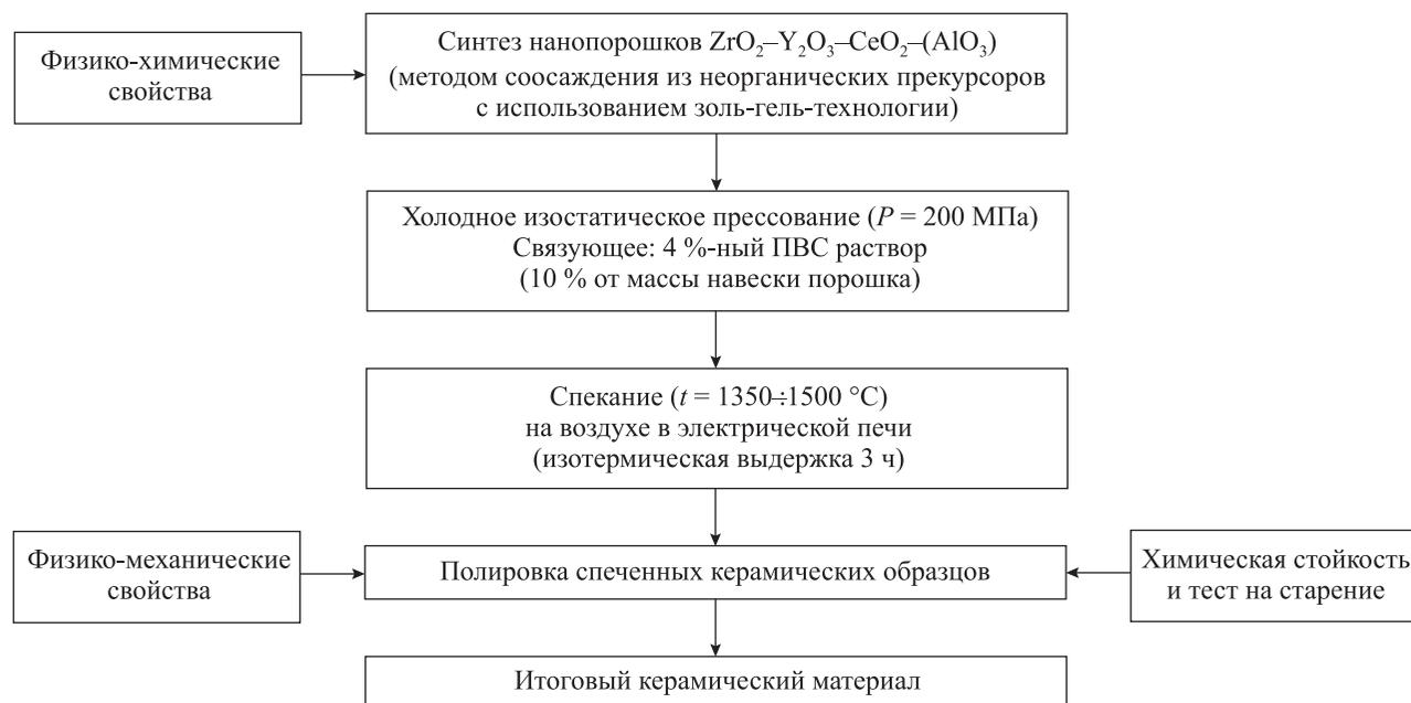
Рис. 7. Схема технологического цикла изготовления керамики
