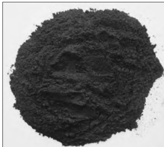
Рис. 3. Активированный уголь из скорлупы ореха анакардиума ( d \leq 0,16 мм)
