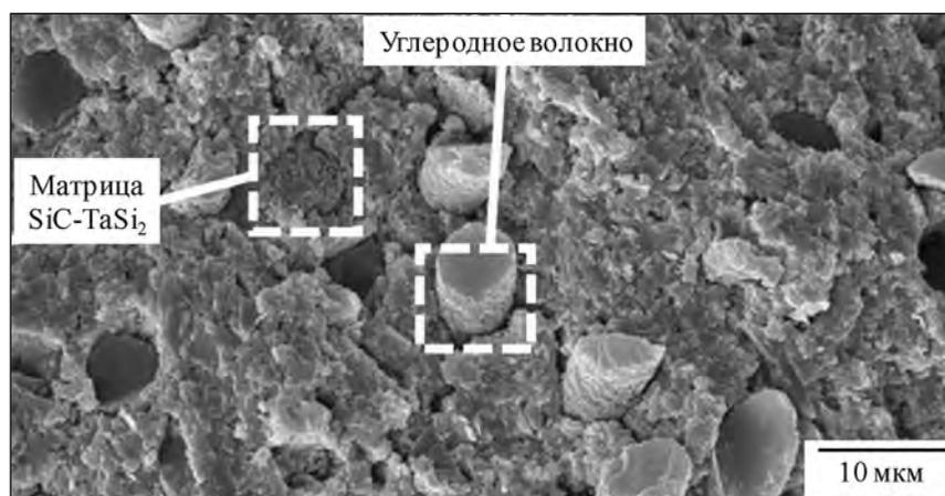
Рис. 6. СЭМ-изображение излома в образце  $SiC-TaSi_2$ , упрочненном  $C_B/in situ SiC_{нв}$  (смесь 3.3, 30 об.%  $C_B$ ,  $d = 15$  мм)
