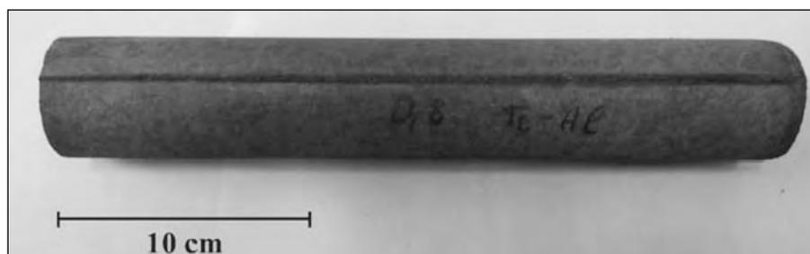
Рис. 6. Мембрана на основе нанопористого материала Ti–Al
