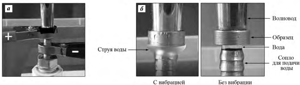
Рис. 3. Вид установки для кавитационных испытаний
