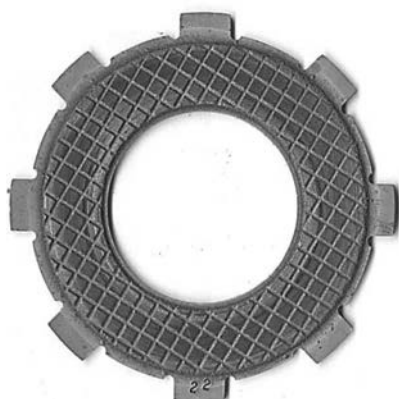
Рис. 2. Образец фрикционного диска для проведения испытаний
