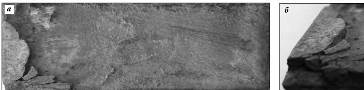
Рис. 4. Проявление сдвига и выноса спрессованного порошкового слоя \text{Cr}_3\text{C}_2 —Ti при скользящем нагружении a — общий вид образцов, б — сохранение порошкового слоя на начальном участке
