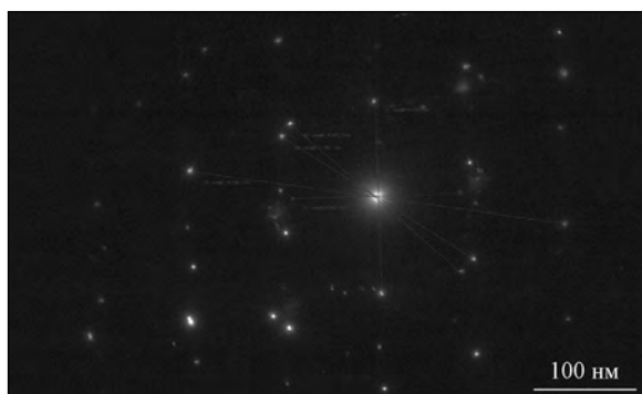
Рис. 9. Фурье-трансформации выделившейся с поверхности фазы
