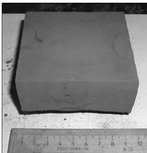
Рис. 6. Фотография полученного спека состава 3 массой 500 г
