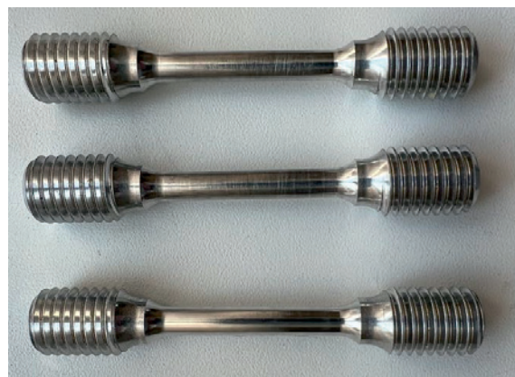
Рис. 7. Образцы из дисперсно-армированного МКМ для испытаний на растяжение
