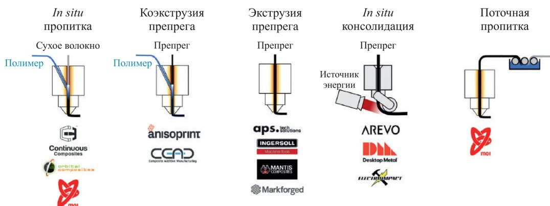
Рис. 1. Схемы реализации процесса и основные компании по 3D-печати непрерывно армированных ПКМ на базе промышленного робота [32]
