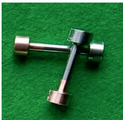
Рис. 4. Образцы для механических испытаний
