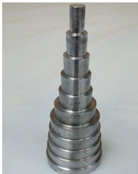
Рис. 2. Цилиндрическая оправка с переменным диаметром
