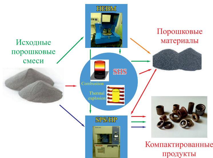
Рис. 5. Схема возможных маршрутов получения высокоэнтропийных материалов с использованием СВС
