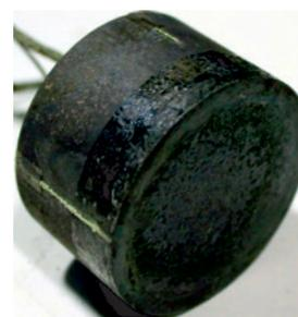
**Рис. 5.** Результаты газодинамических испытаний образца-калориметра из стали 12Х18Н10Т со стеклокерамическим покрытием и его внешний вид после 7 циклов испытаний
