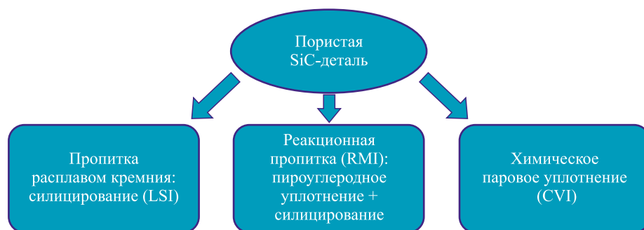
Рис. 1. Варианты реализации уплотнения пористых заготовок деталей из SiC
