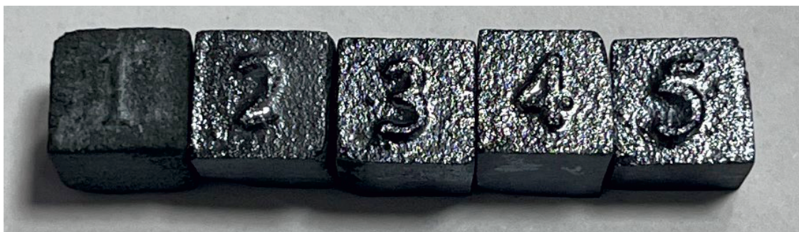
Рис. 4. Кубические образцы – бывшие пористые СЛС-заготовки, прошедшие стадии пироуглеродного уплотнения и силицирования
