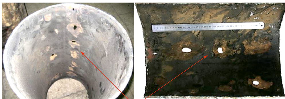
Сквозная язвенная коррозия по нижней образующей трубы
